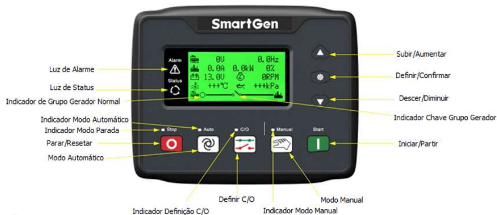
Figura 3 - Indicações do Painel Frontal – Série HGM4010N/HGM4010NC/HGM4010CAN
