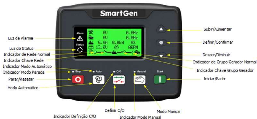
Figura 4 - Indicações do Painel Frontal – Série HGM4020N/HGM4020NC/HGM4020CAN
